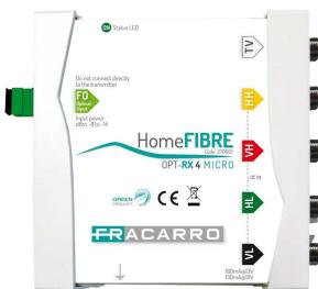
El receptor **OPT RX 4 MICRO** convierte la señal óptica de entrada en una señal coaxial disponible en las 4 polaridades del satélite (VL, HL, VH, HH) y una salida de TV independiente disponible en el conector coaxial dedicado. El receptor puede alimentarse directamente desde las polaridades de salida. El producto está equipado con un LED verde multifunción que proporciona al instalador información diversa:
